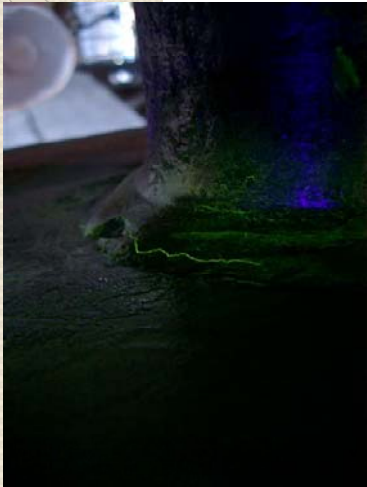
CRICCA LONGITUDINALE IN SALDATURA CIRCONFERENZIALE AL BOCCELLO
