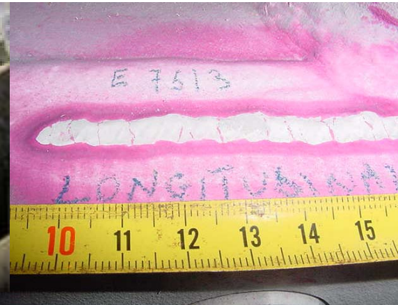
CRICCA trasversali IN SALDATURA LONGITUDINALE
