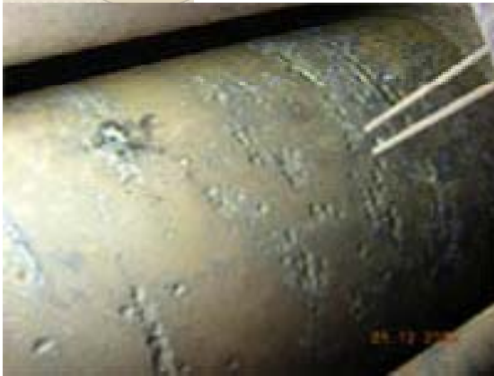
ATTACCO DA OSSIGENO SUL FOCOLARE
