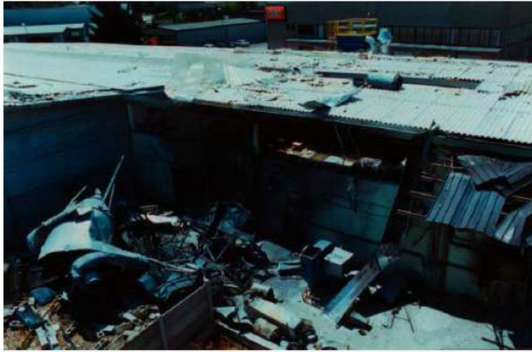
IMPIANTO DI ASPIRAZIONE ESPLOSO VISTO DALL'ALTO
